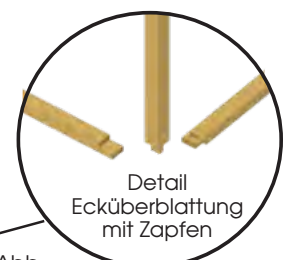
Abb. Konstruktion mit Fundamentrahmen
